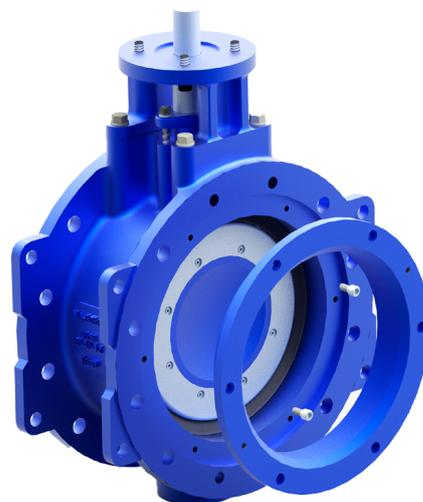
As VÁLVULAS TIPO BORBOLETA VA-505 S Bi excêntrica, são projetadas de acordo com a norma AWWA C504 e utilizadas com função de bloqueio de fluxo ou também como controle de vazão em uma tubulação. Permite fluxo em ambos os sentidos.
